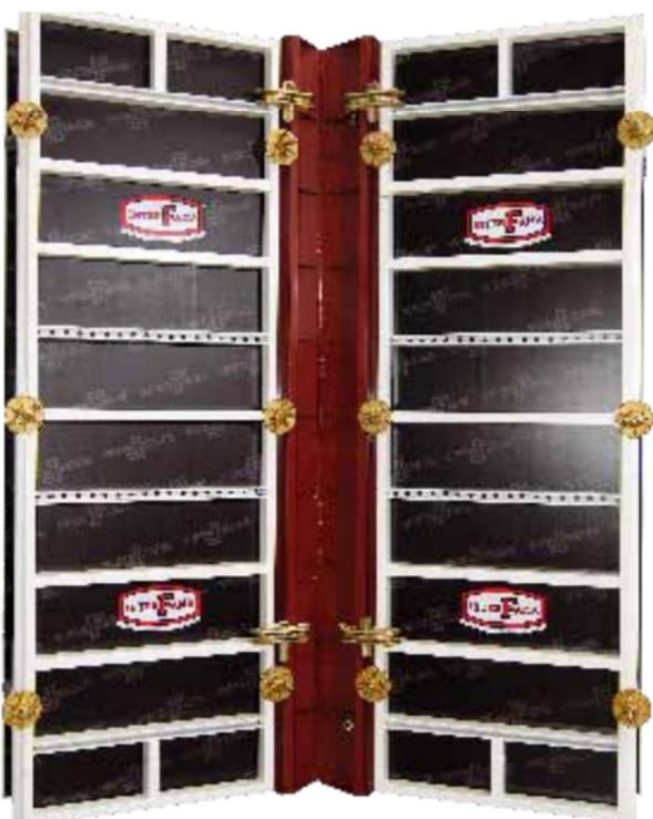
Die Scharnierecke kann als Aussen- und als Innenecke verwendet werden, wobei schiefwinklige Ecken ab 80° bis 170° realisiert werden können. Die Scharnierecke kann auch auf 90° fixiert werden und wird so zur normalen Innenecke.
